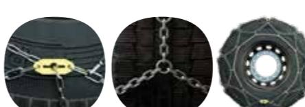
**Veriga s poenostavljenim montažo, izdelana posebej za avtobuse.** S togim lokom in brez notranjih priklopov, za enostavno montažo in demontažo na zunani strani kolesa.
