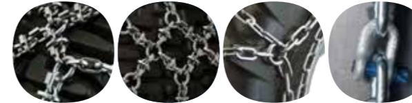
Veriga v dvojni rombasti izvedbi, izdelana za uporabo v ekstremnih zimskih razmerah. Primerena samo za vozila s širšimi pnevmatikami. Z ojačanimi členi in varjenimi ploščicami, za zahtevno in neprekinjeno uporabo na snegu in ledu. Idealna za pluženje snega.
