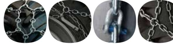
Veriga v rombasti izvedbi, izdelana za uporabo v težjih zimskih razmerah. S ploščatimi oprijemnimi elementi zagotavlja boljši oprijem. Za zahtevno uporabo na snegu in ledu.
