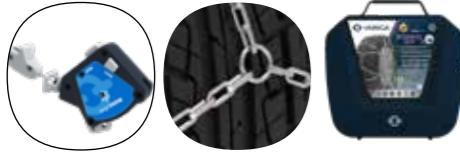
**13 mm veriga z avtomatskim zatezanjem in prilagajanjem pnevmatiki, izdelana za vozila SUV, avtodome in terenska vozila. Dve patentirani samozatezni ključavnici »STOP&GO«. Ustavljanje vozila in zatezanje verige ni potrebno.**
